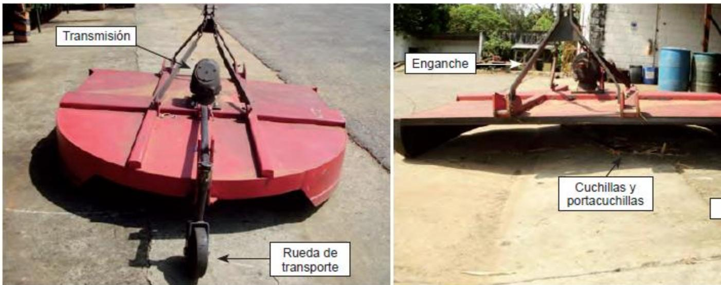
Figura 28. Partes del cortamalezas (fuente: autor)
