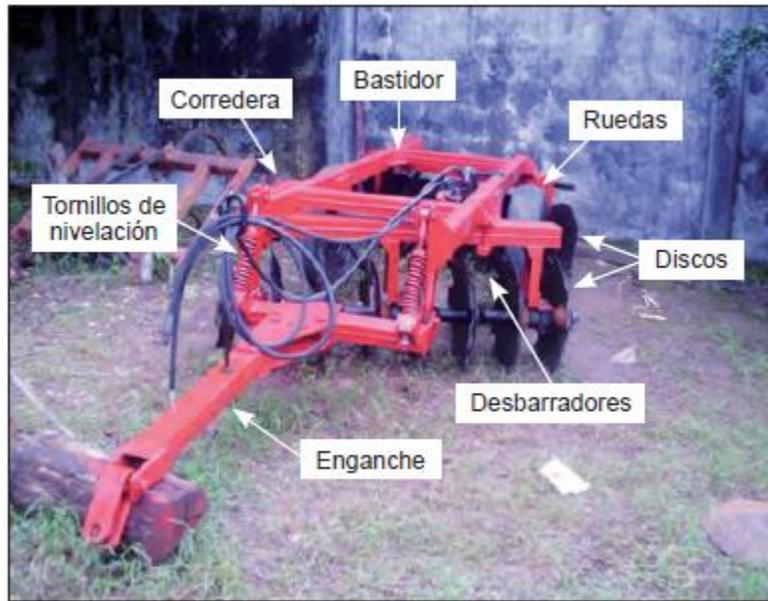
Figura 15. Partes de la rastra de discos (foto del autor).
