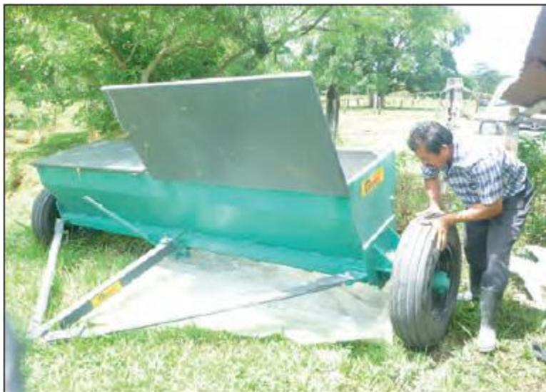
Figura 24. Calibración abonadora horizontal (foto del autor).
