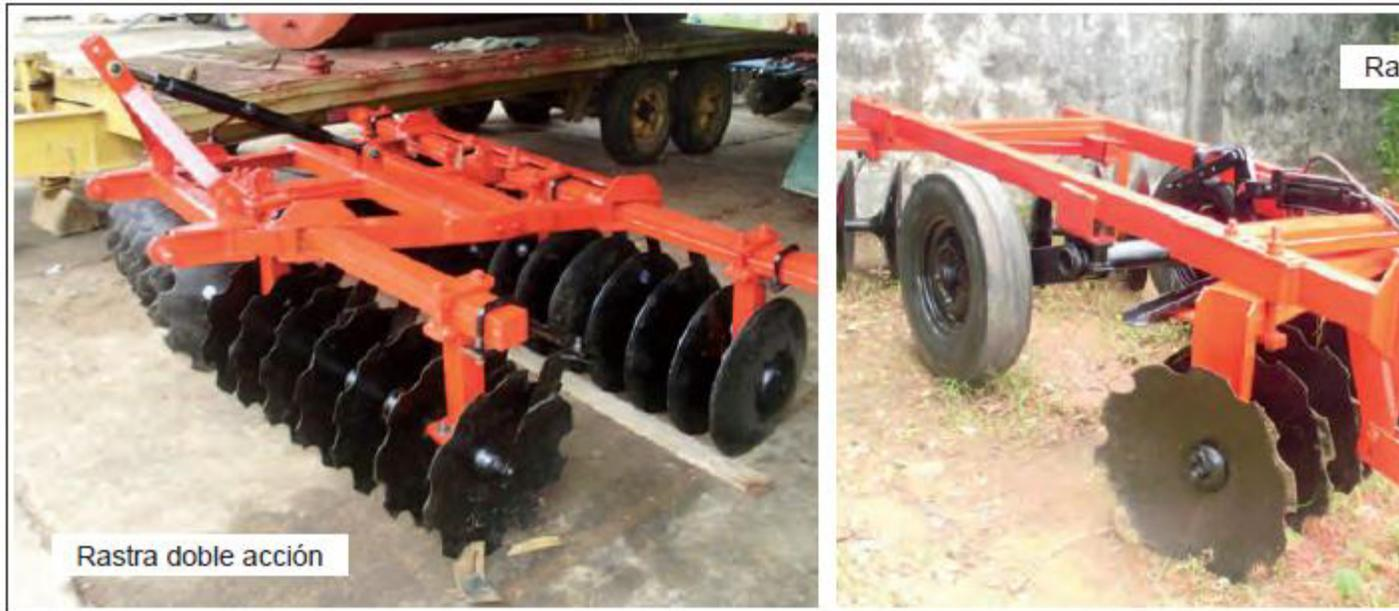
Figura 16. Clasificación de acuerdo con la disposición de los discos (fotos del autor ).
